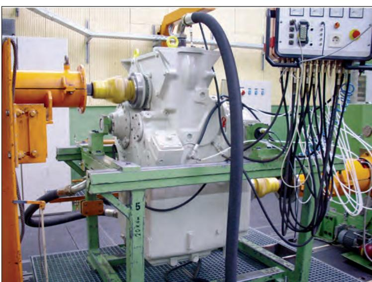
Slika 11: Hidraulički prijenosnik L3r2V2 na ispitnom stolu
