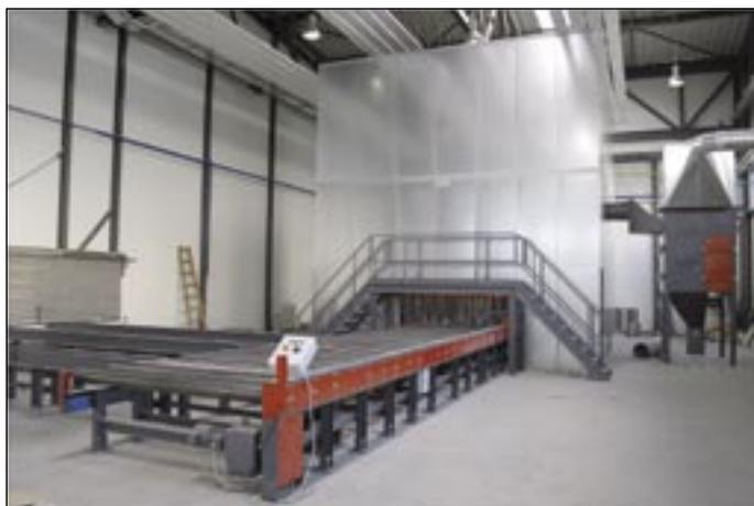
Slika 7: Protočna sačmara za limove i profile
