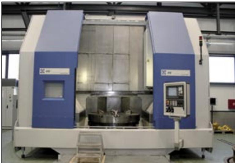
Slika 2: Numerički upravljana tokarilica za obradu profila (CNC-tokarilica)
