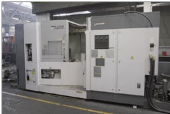
Slika 8: Horizontalni obradni CNC-centar
