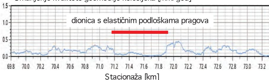
Slika 5: Degradacija kolosijeka s ugrađenim podloškama pragova i bez njih
