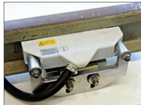
**Slika 8: Senzor kotača WSD s pričvršćenjem na nožici tračnice**
