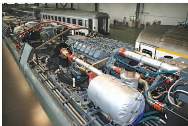
Slika 7: Dizel-motor ugrađen na krov vozila
