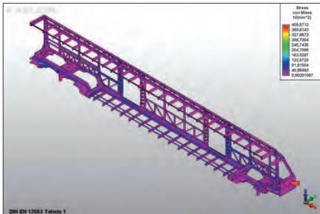
Slika 3: Raspored naprezanja u konstrukciji
