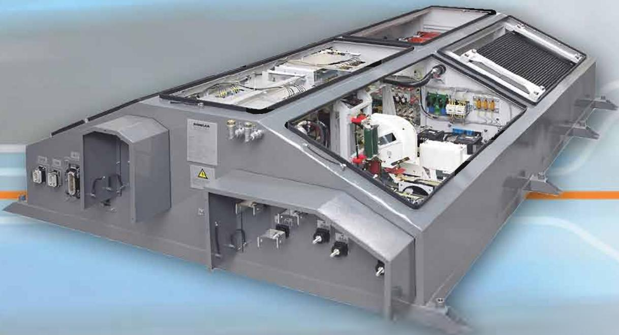
Sva oprema pretvarača glavnog pogona i pretvarača pomoćnih napajanja, zajedno s rashladnim sustavom, smještena je u jedan sanduk, predviđen za krovnu montažu, pa je postignut visoki stupanj integracije i optimalna konstrukcija za lako održavanje. Povećana "gustoća snage" ove generacije pretvarača omogućava kompaktnije i laganije izvedbe vučnih vozila.
