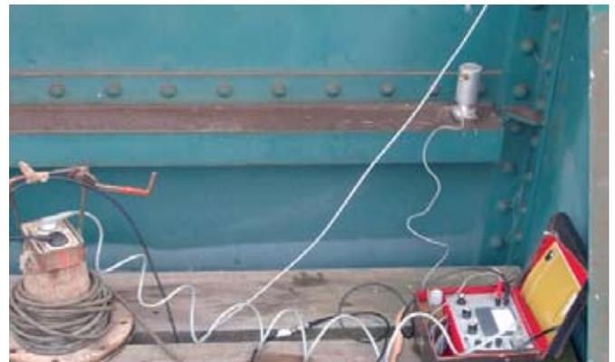
Slika 15. Vibrometar za mjerenje dinamičkih pomaka i akceleracija (Hottinger SMU)
