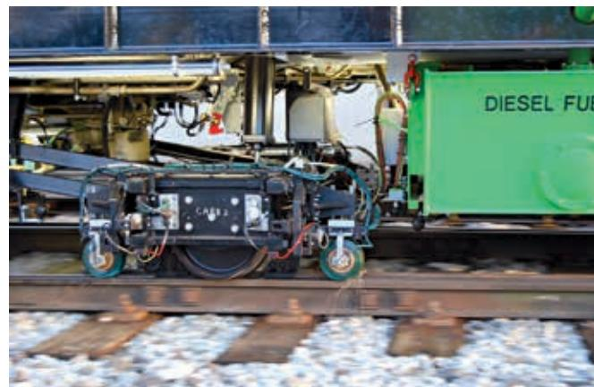
Slika 5. Moderni ultrazvučni senzori (ugrađeni u gumenim kotačima) ne zahtijevaju održavanje i troše мало воде
