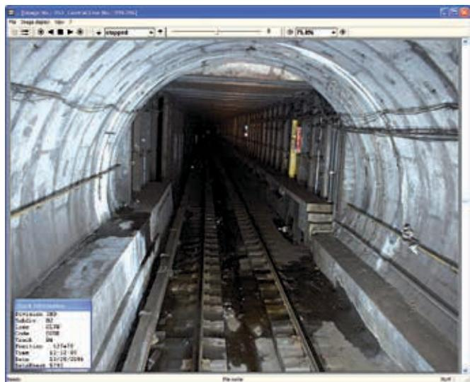
*Slika 7. Primjena visokodjelotvornog sustava za osvjetljenje stijenki tunela omogućuje služenje videosustavom na neosvjetljenim ili slabo osvjetljenim dijelovima pruge*
