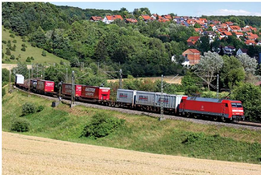
**Slika 2. Suvremeni intermodalni prijevoz - prenosivi kamionski sanduci**
