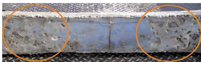
Slika 2. Prag s podloškom nakon 190 milijuna tona opterećenja s udubljenjima u Sylomeru®
