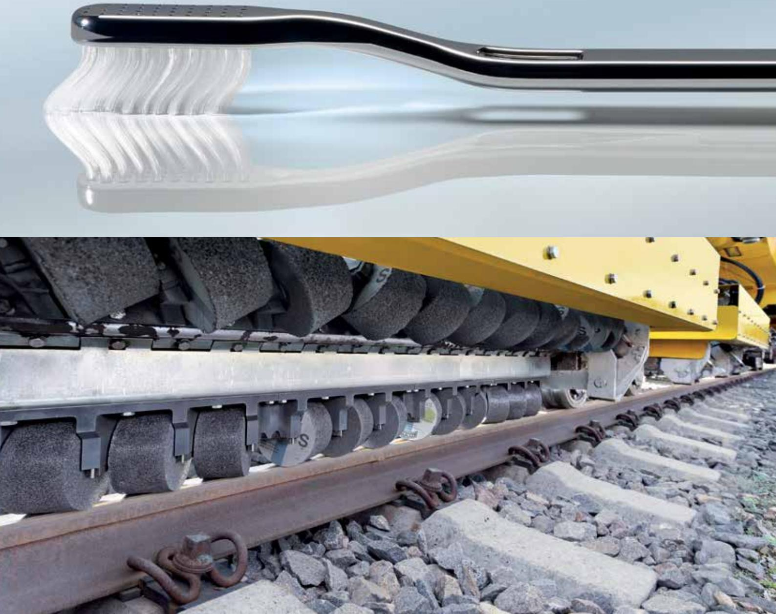
Redovito korišteno, zaštitno High Speed Grinding (visokobrzinsko) brušenje tračnica suzbija pojavu trošenja tračnica već na početku te produljuje vijek trajanja ležišta tračnica. Osim toga, preporučuje se preventivno brušenje tračnica kao učinkovita i povoljna mjeru za zaštitu od buke. Tehnologija je primjerena za sve željezničke sustave – od superbrzih pruga do mreža gradskih željeznica – i sve to bez zatvaranja pruga.
