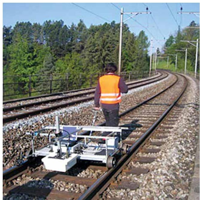
Slika 5. Višekanalni georadarski sustav instaliran na posebna kolica [19]
