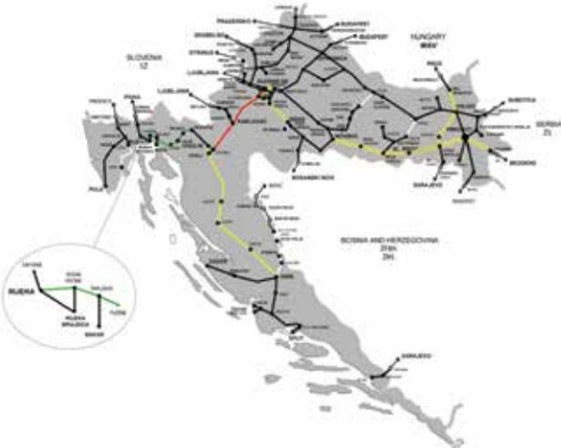
Slika 3: Karta prikazuje različite pružne dionice koje su prošle ispitivanje u sklopu sporazuma te koje su djelomično podvrgnute glodanju. Žutom bojom označene su dionice na kojima su izvedena četiri postupka ispitivanja tračnica, zelenom bojom označene su dionice na kojima je glodanje već izvedeno, crvenom bojom označene su dionice na kojima se planira glodanje, a bijelom bojom označene su pruge na kojima se trenutačno ne vozi (izvor: HŽ Infrastruktura).
