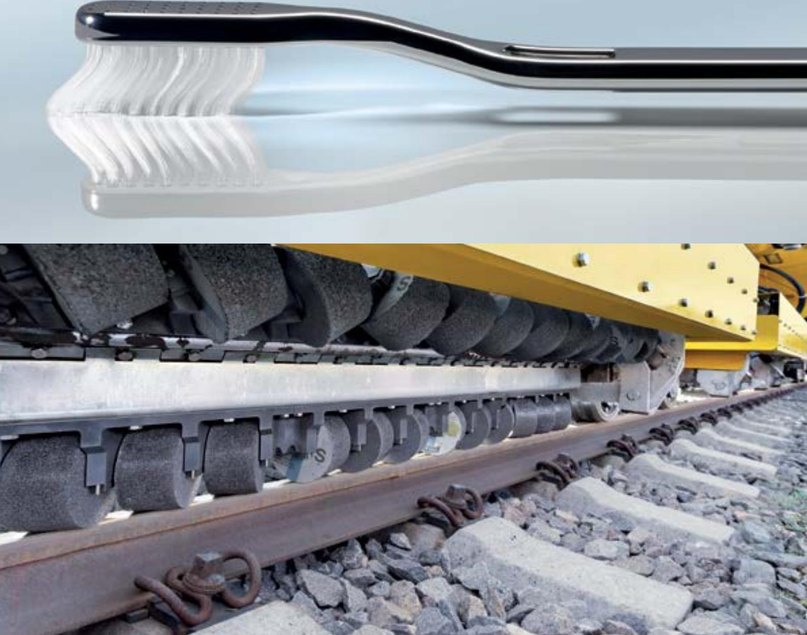
Redovito korišteno, zaštitno High Speed Grinding (visokobrzinsko) brušenje tračnica suzbija pojavu trošenja tračnica već na početku te produljuje vijek trajanja ležišta tračnica. Osim toga, preporučuje se preventivno brušenje tračnica kao učinkovita i povoljna mjera za zaštitu od buke. Tehnologija je primjerena za sve željezničke sustave – od superbrzih pruga do mreža gradskih željeznica – i sve to bez zatvaranja pruga.
