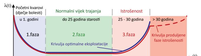
Slika 8. Dijagram kade za kolodvorske SS-uređaje s produljenom fazom istrošenosti
