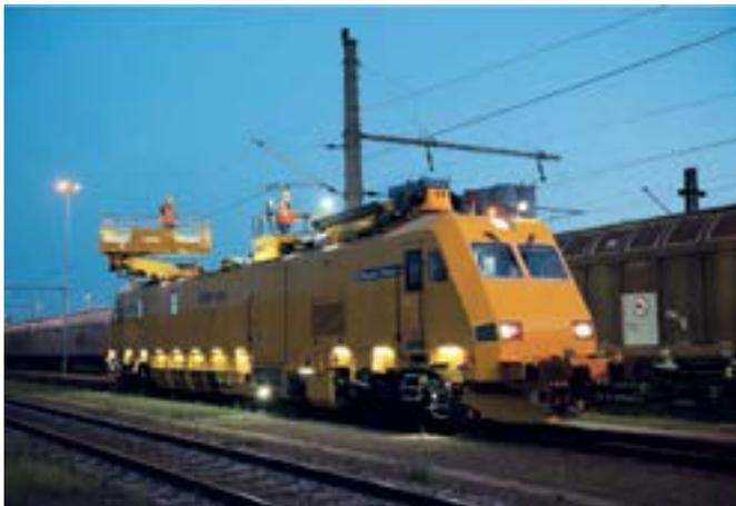
**Slika 1. Vozilo za brze intervencije MTW 160 za mrežu željezničkih pruga velikih brzina u Kini (funkcionalna ispitivanja u Austriji)**
