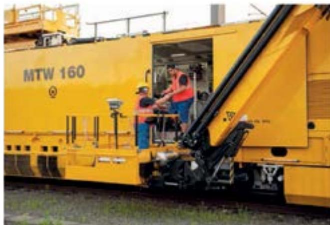
Slika 5. Istovar iz vozila dok je radna platforma spuštena
