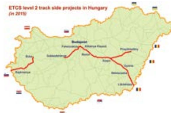
Slika 6: Trenutačni mađarski projekti sustava kolosiječnih uređaja ETCS-a razine 2
