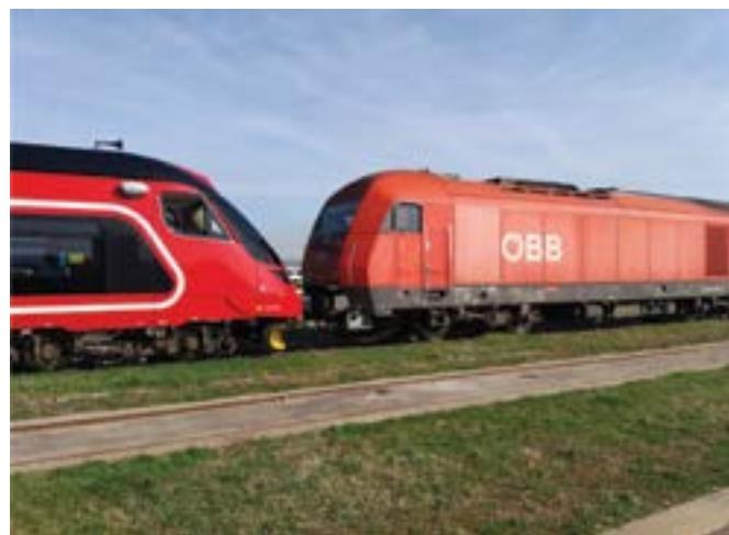
*Slika 3. Spajanje vlaka pomoćnim kvačilom na lokomotivu RCC-a*
