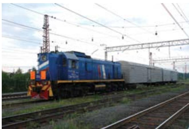
*Slika 2. Iako su najveći djelovi željezničkih pruga između Kine i Europe elektrificirani, na nekim kraće željezničke pruge vuču vlakova obavljaju dieselske lokomotive. Teška dieselska manevarska lokomotiva TEM18D 056 vuče kraći teretni vlak kroz kolodvor Šuvakiš sjeverno od Jekaterinburga u Rusiji.*
