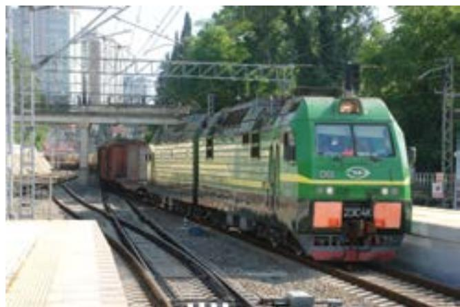
*Slika 3. Teška električna 3kV lokomotiva 2ES4K 061 vuče teretni vlak kroz kolodvor Soči u južnoj Rusiji. Iako zbog gradnje novih cjevovoda udio nafte i naftnih derivata u Rusiji pada, ovi tereti još uvijek čine važan dio teretnog prometa u Rusiji, i na relacijama između Kine i Rusije.*
