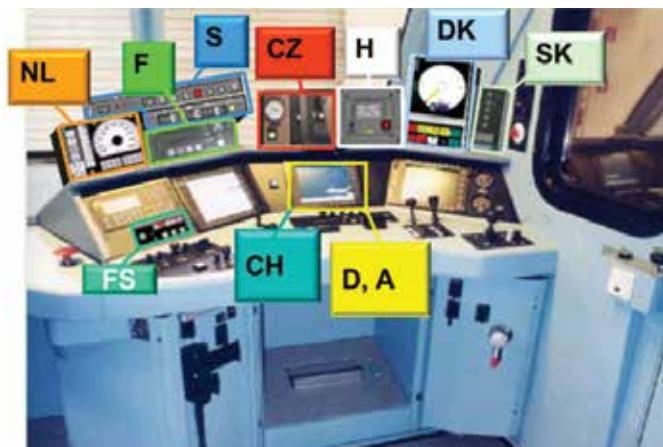
Slika 1. Vozačka kabina sa svim europskim sustavima kontrole vlakova
