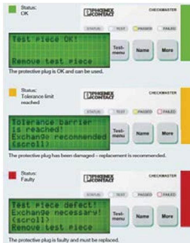
Slika 14. Primjer izvješća nakon ispitivanja prenaponske zaštite
