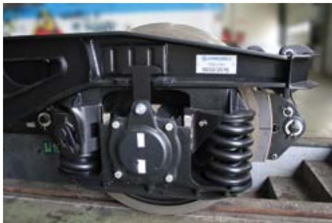
Okvir okretnog postolja izrađen je iz čeličnih limova (uzdužni i poprečni nosači), čeličnih profila (čeoni nosači) i čeličnih odlevaka (kliznice i okretna zdjela) međusobno spojenih zavarivanjem. Na poprečnome nosaču okretnog postolja ugrađena je standardna okretna zdjela s plastičnim samopodmazujućim umetkom.
