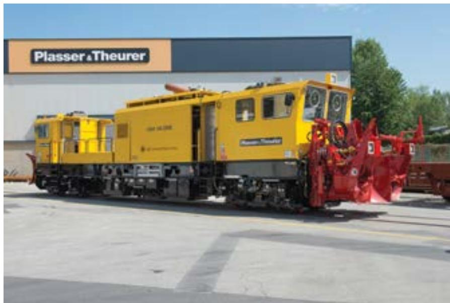
Teško motorno pružno vozilo OBW 100.256 S s uređajem za čišćenje snijega velikog kapaciteta („freza“)
