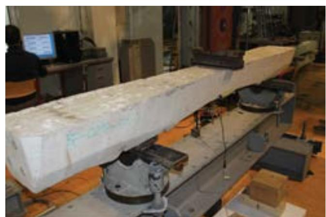
Slika 10. Statičko ispitivanje središnjeg presjeka na negativan moment
