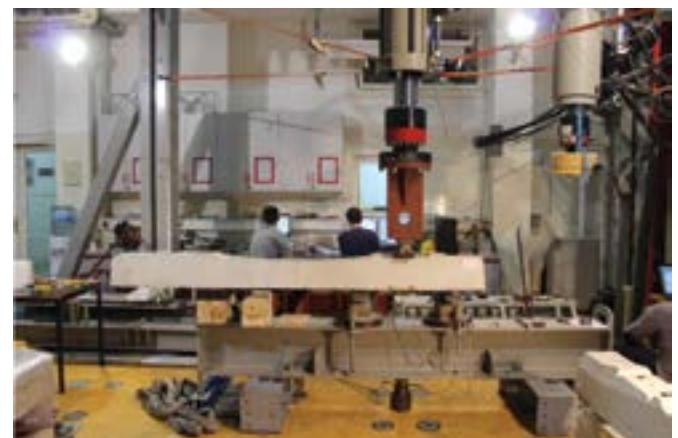
Slika 16. Dinamičko ispitivanje na mjestu ležišta tračnice
