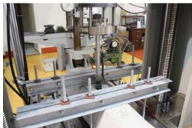
Slika 28. Vlačno ispitivanje plastičnih uložaka
