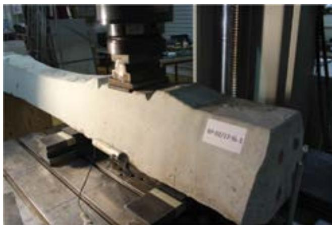
Slika 4. Statičko ispitivanje na mjestu ležišta tračnice
