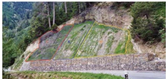
Slika 7. Testni poligon za evaluaciju geopletiva za zaštitu od erozije (testni poligon okrenut je prema jugozapadu te se nalazi na rijetko naseljenom području koje je izloženo ekstremnim promjenama vremena)
