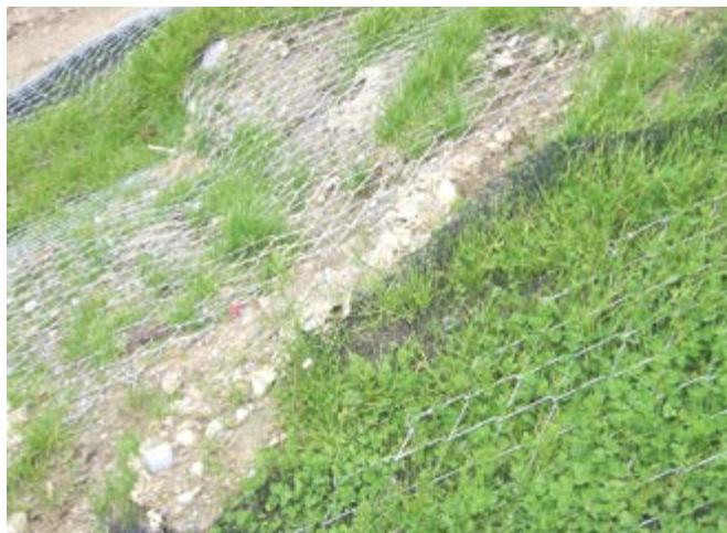
**Slika 9.** Testni poligon otprilike 10 tjedana nakon hidrosjetve i obilne kiše. Na lijevoj strani slike nalazi se referentna površina bez geopletiva za zaštitu od erozije s manje od 10 posto ozelenjene površine. Na desnoj strani vidi se površina s geopletivom s više od 90 posto obnovljene vegetacije.
