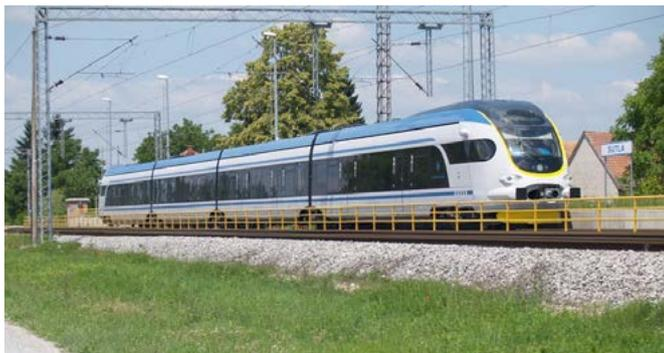
Slika 5. Niskopodni elektromotorni vlak Končar
