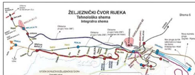
**Slika 7. Tehnološka shema riječkoga željezničkog čvorišta po višoj varijanti**
