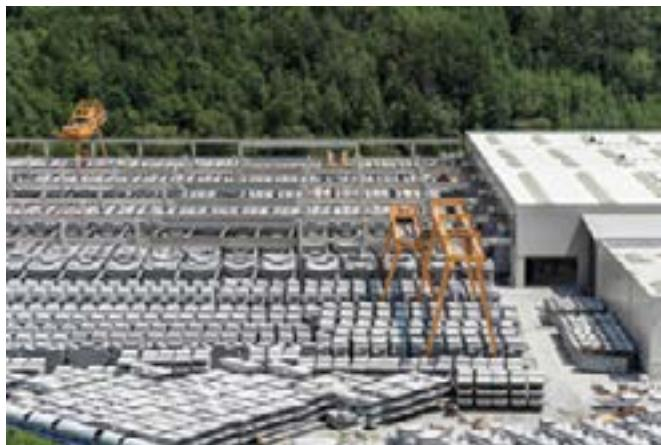
*Slika 2: Skladište betonskih elemenata oplate tunela na gradilištu Mules u Italiji*
