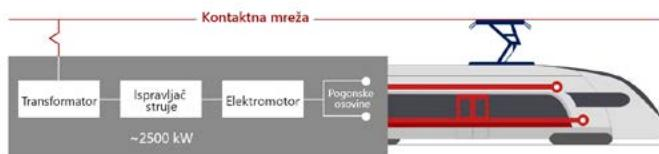
**Slika 1. Ilustracija pogonskoga sustava za elektromotorne vlakove**
