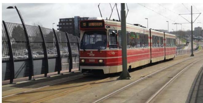
Slika 4. Corkelast® Embedded Rail System (sustav ugrađenih tračnica) na kolničkoj konstrukciji, u betonskome kanalu
