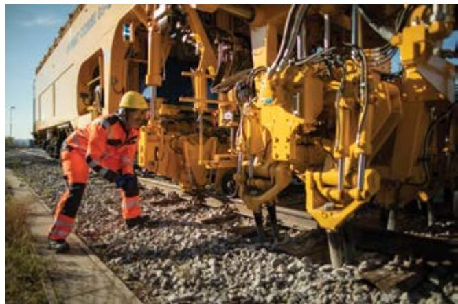
*Pregled stroja u okviru ugovora za održavanje može se provesti izravno na radilištu – idealno zajedno sa provođenjem funkcionalnih testova*
