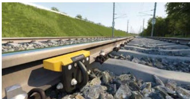
*Fauscherovi senzori kotača RSR123 izrazito su otporni na elektromagnetne smetnje*
