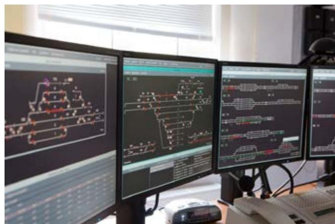
*Slika 3. Centar središnjega upravljanja prometom – prikaz povećane slike pojedinih kolodvora sustava Iltis N na dvama lijevima zaslonima i pregledna slika cijele pružne dionice na desnom zaslonu*
