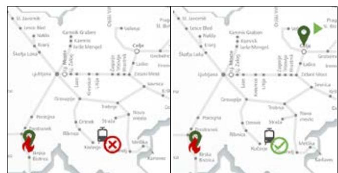
Slika 5. Usporedba sistemske redundancije i georedundancije: (lijevo) bez mogućnosti upravljanja željezničkim prometom u slučaju prirodne katastrofe (npr. požara ili poplave) unatoč sistemskoj redundanciji; (desno) prijenos upravljanja željezničkim prometom s jedne lokacije na drugu u slučaju georedundancije bez prekida željezničkog prometa
