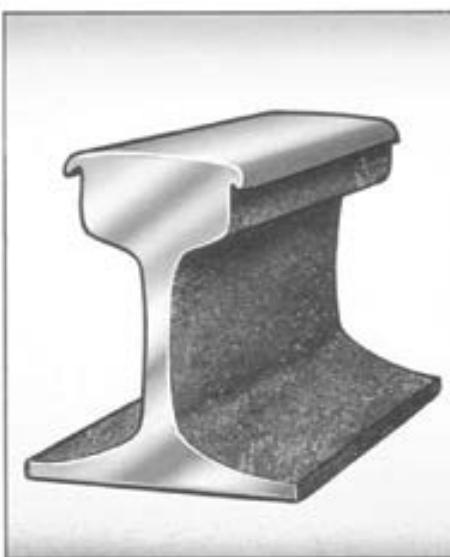
Slika 1. Visinska istrošenost tračnica
