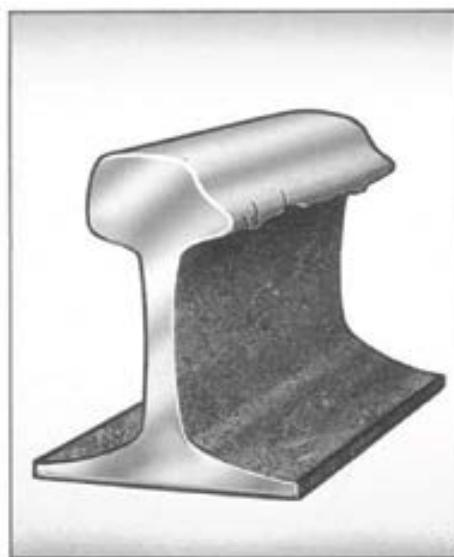
Slika 2. Bočna istrošenost tračnica
