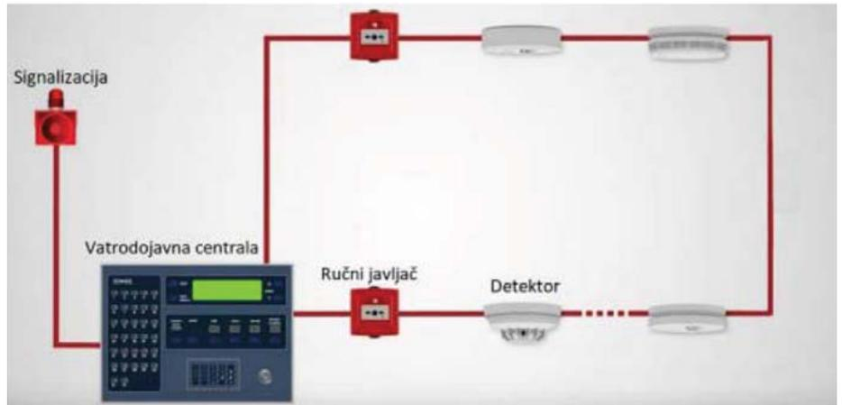
Slika 4. Shema sustava vatrodjave [7]
