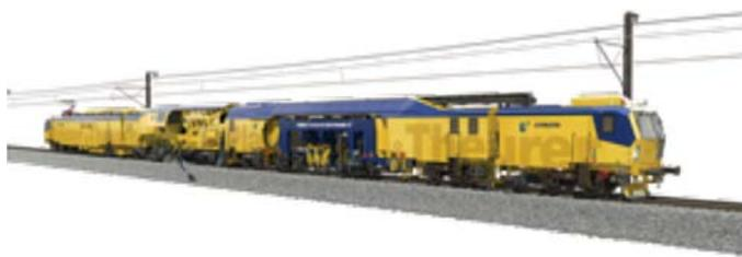
U načinu rada s električnim pogonom, tehnologija hibridnog pogona E<sup>3</sup> omogućuje rad strojeva bez ispušnih plinova.
