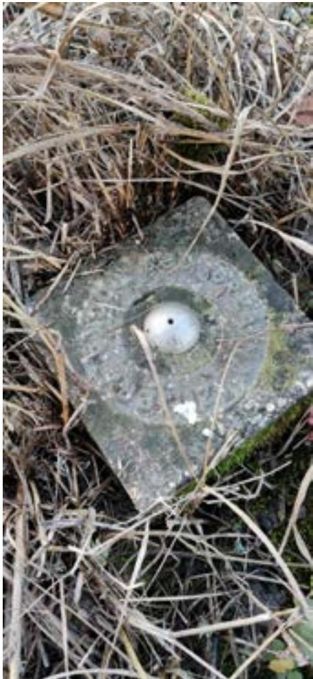
**Slika 4.** Stabilizacija GPS točke 4058
