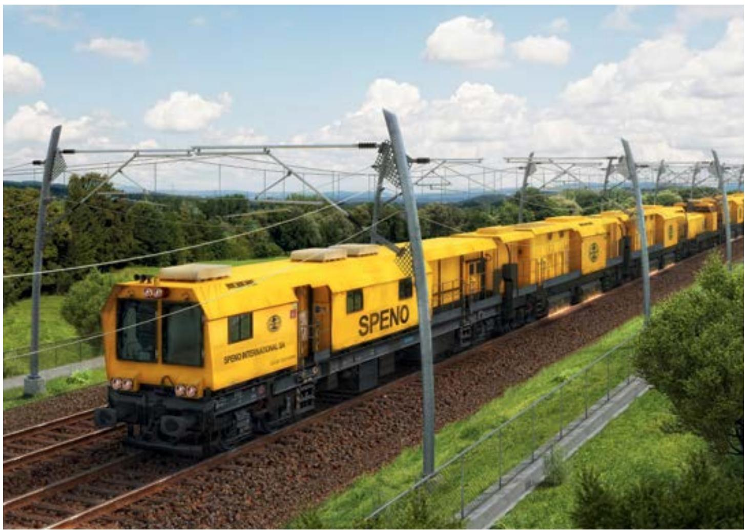
Slika 5. Speno vlak za brušenje tračnica na brzim prugama
