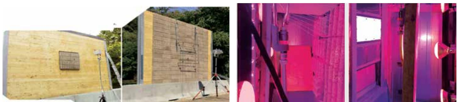
**Slika 4:** Ispitivanje buke na licu mesta prema EN 1793-5 lijevo i desno ispitivanje u klimatskoj komori
