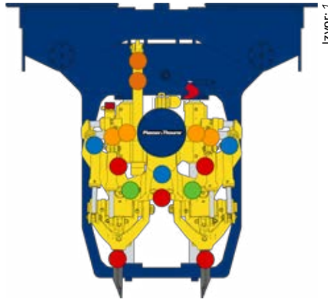
Slika 2. Pametna jedinica za podbivanje univerzalnog stroja za podbivanje Unimat 09-4x4/4s E 3 s ugrađenim senzorima: tenzometri (crvena), kutni pretvornik pomaka (zeleni), akcelometri (plava) i senzori tlaka (narančasta)
