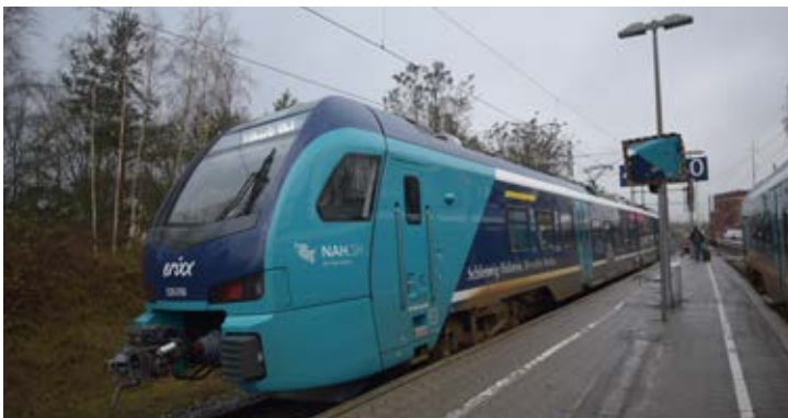
Slika 2. Dvodjelni Stadler Flirt Akku baterijski vlak 526 016 za vrijeme punjenja baterija, s podignutim pantografom
