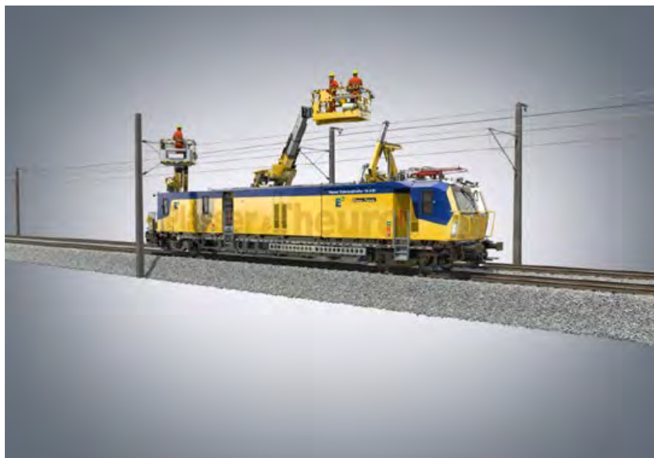
Plasser CatenaryCrafter 15.4 E 3 Opremljen željezničkim kranom i slobodno okretnom podiznom radnom platformom.
