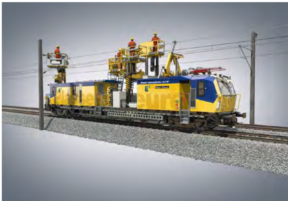
Plasser CatenaryCrafter 15.4 E 3 Opremljen željezničkim kranom i trodijelnom podiznom radnom platformom.
