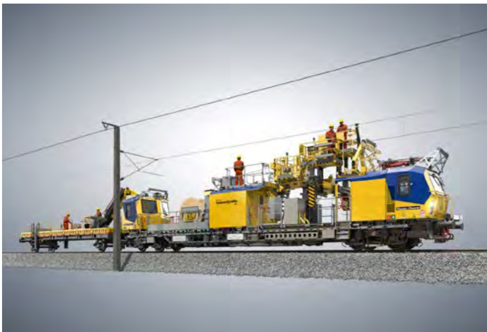
Plasser CatenaryCrafter 15.4 Opremljen željezničkim kranom i trodijelnom podiznom radnom platformom, uključujući tovarnu površinu i okretnu kabinu kрана.
