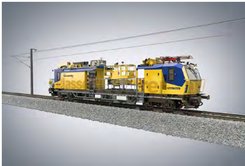
Plasser CatenaryCrafter 12.5 Opremljen željezničkim kranom i slobodno okretnom podiznom radnom platformom.
