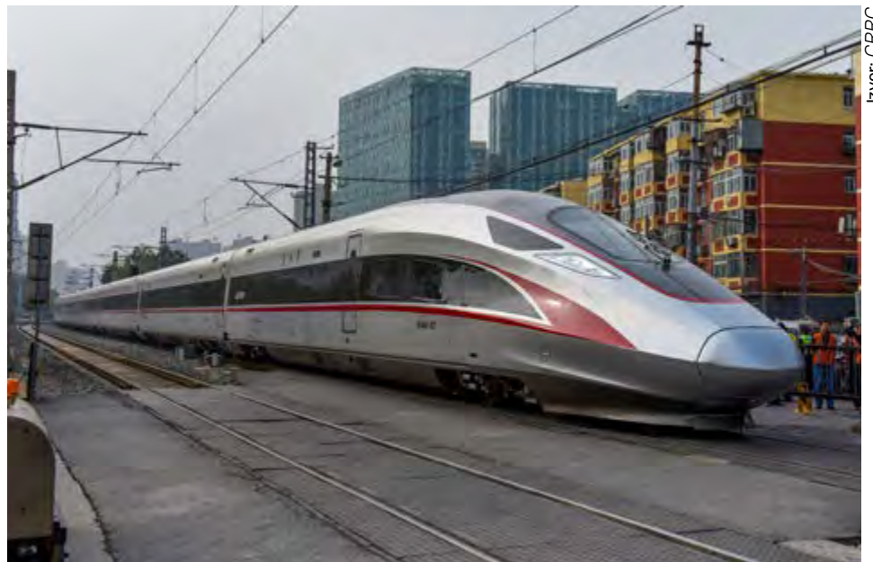
Slika 3. Vlak CR400AF koji je proizvela joint venture tvrtka CRRC Qingdao Sifang Bombardier i koji se u detaljima dizajna razlikuje od ostalih vlakova CR400 Fuxing
