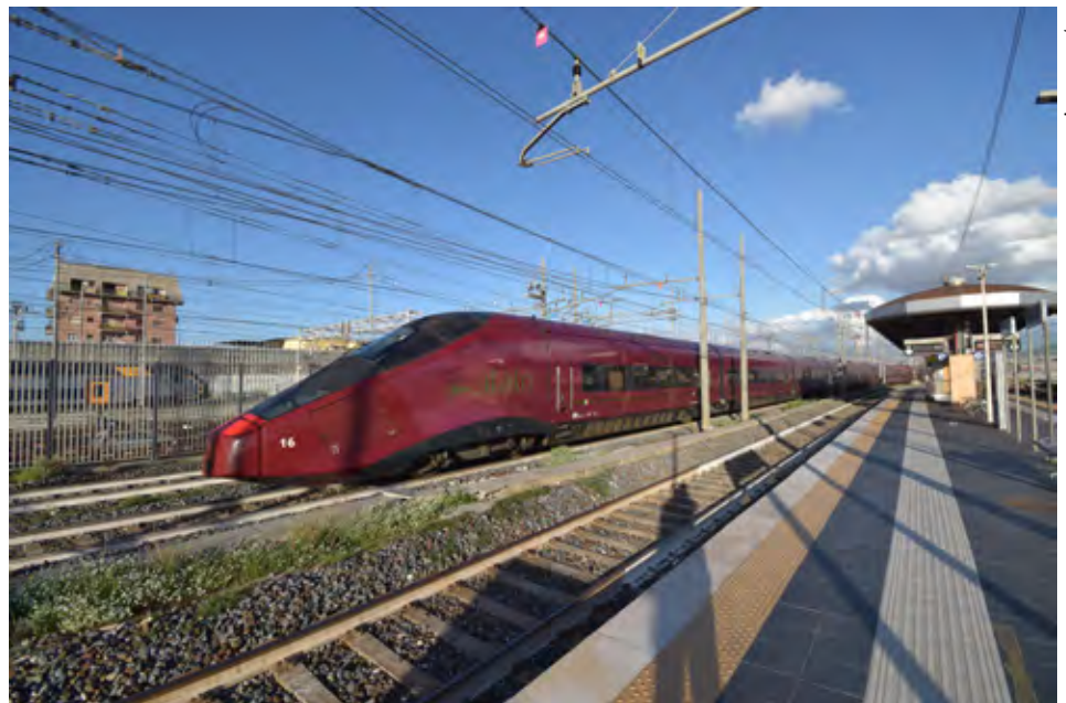
Slika 3. Perjanicu flote Itala čini 25 vlakova ETR 575, čija maksimalna brzina iznosi 300 km/h.
