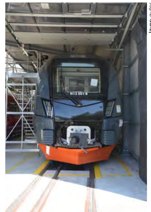
Slika 3. Dizajn kabine strojvođe za vlak Norske Tog je varijacija klasično dizajna upravljačnice vlakova FLIRT
