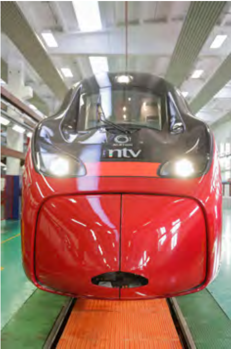
Slika 2. Iako su poznati i pod imenom Pendolino, vlakovi ETR 675 nisu opremljeni nagibnom tehnikom.
