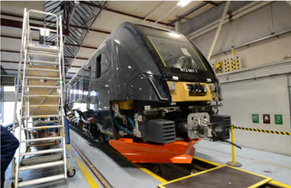
Slika 2. Profil valsa za Norske Tog je veći od normalnog profila vlakova za europski normalni kolosijek. Ta činjenica zahtijeva posebna logistička rješenja za prijevoz vlaka u Berlin na Innotran
